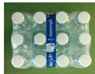
*Aplicação da fita adesiva da alça numa depressão (entre dois recipientes), aplicar filme com maior alongamento à ruptura*
