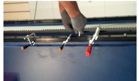
Abbildung 5: Schraubzwingen an Führungsschiene
